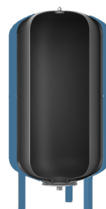
Secțiune vas de expansiune cu membrană tip sac (imagine cu caracter ilustrativ)
