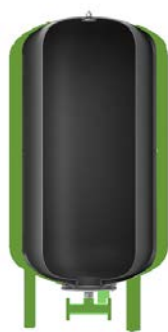
Secțiune vas de expansiune Reflex DT cu membrană tip sac (imagine cu caracter ilustrativ)
